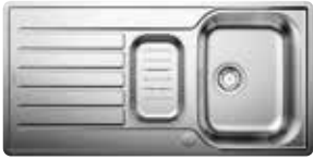
Multifunktionsschale aus Edelstahl, Ablaufgarnitur mit Raumsparrohr, 2 x 3 ½" Korbventil mit Ablauffernbedienung (Drehbetätigung) für das Hauptbecken
